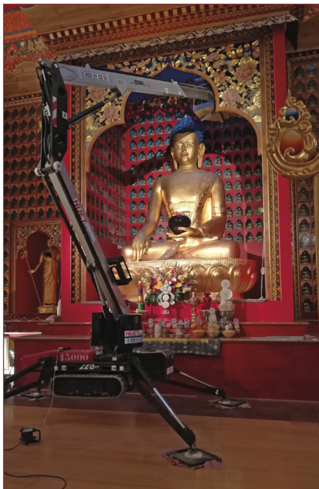
Une nacelle à commande électrique transporte les artisans dans tout l'espace du temple
